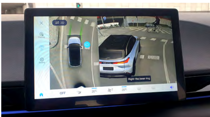
System kamer monitorujących otoczenie pojazdu 360°
